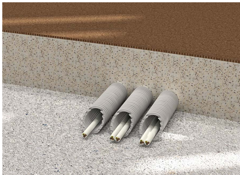
Posa annegata nel massetto
